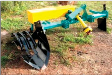
Նկար 2. ՎՊՆ-2ՄՍ կախովի գութան
