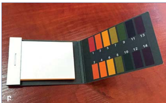
Նկար 90. Հողի թթվային ռեակցիայի (pH) որոշարկման միջոցներ՝ ա) պեհաշմետր, բ) լսկմուսի թուղթ
