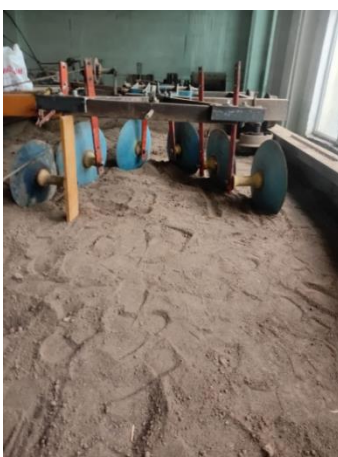
Նկ. 11. Բարելավված հատուկ պրոֆիլի սկավառակային մարտկոցի լաբորատոր փորձարկումից դրվագներ
