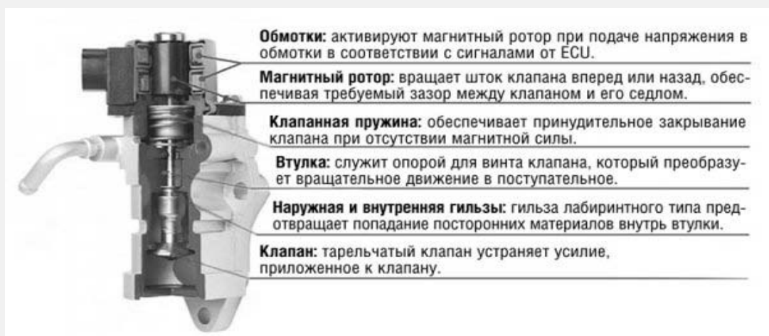
Նկ. 4. Էլեկտրոնային կառավարմամբ գործադրվող EGR փականի օրինակ:
