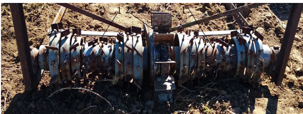
Սկ. 1. Ռոտորային կոշտամանրիչի ընդհանուր տեսքը. 1 - կոշտամանրիչ, 2 - հողակառչիչավոր թմբուկ:
