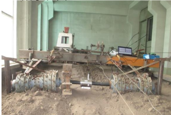
Նկ. 11 Կոշտամանրիչի լաբորատոր փորձարկման կայանքի ընդհանուր տեսքը:
